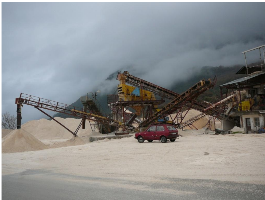
Slika 5. Izgled drobiličnog postrojenja kamenoloma „Nalježići“
